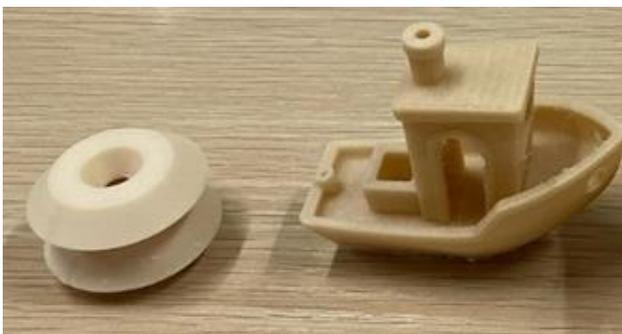
图 5. CNF 复合 PLA 的 3D 打印模型
