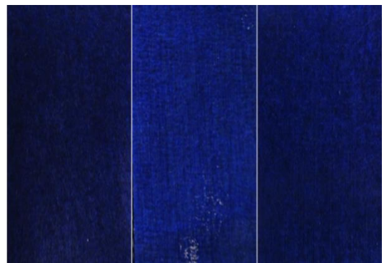
図 3. インキ化時の塗膜写真 (左:エマルション B、中:エマルション B/ロジン混合物、右:PE-2189)
